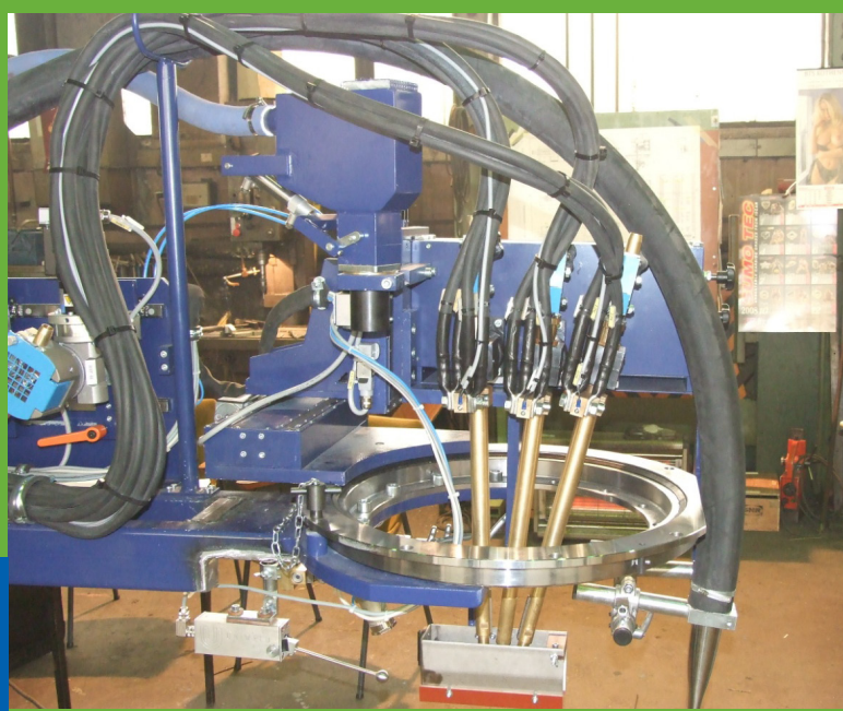
Glava za dubinsko zavarivanje do 250 mm - sa jednom žicom, tandem izvedba
